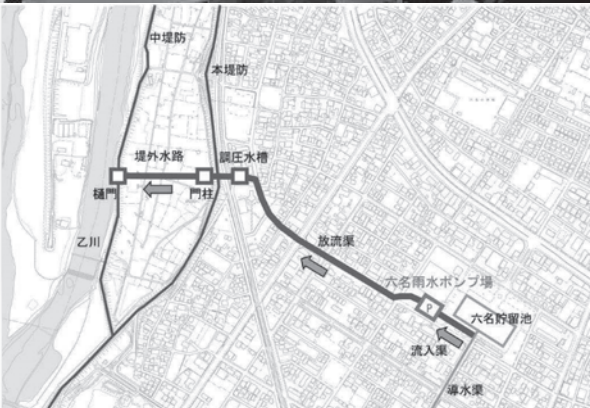
▲六名雨水ポンプ場施設 乙川までの排水経路
