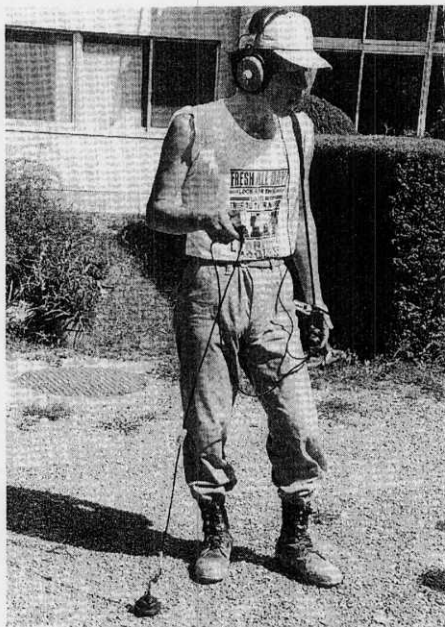
▲ 埋設水管の漏水を探知
