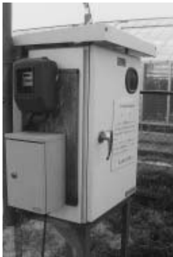
▲観測したデータを送り出す有線ロボット気象計
