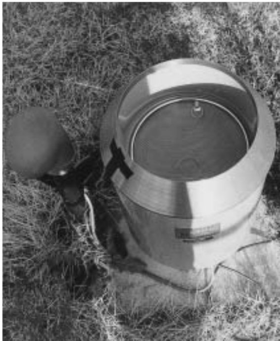
▲直径20cmの転倒まず型雨量計
