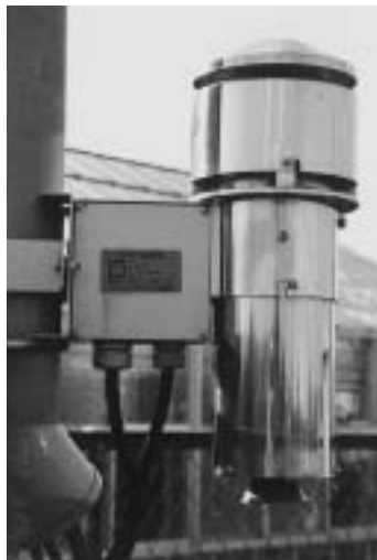
▲地上1.5m（世界基準）の筒の中に納められた温度計
