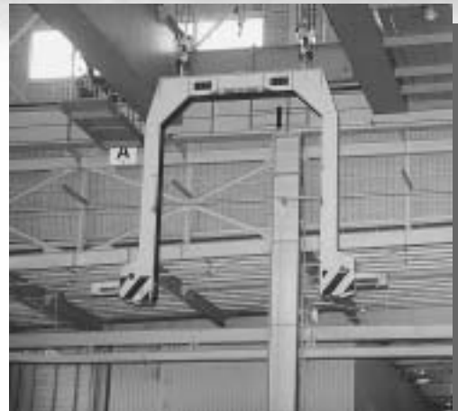
▲車体をつり上げる大型クレーン
