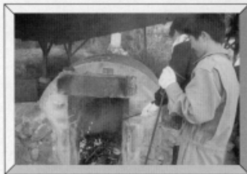
▲裏山にある耐火レンガでできた炭焼き穴窯（河合中）
