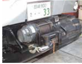
▲通行を妨げる障害物を撤去するために装備されたウインチ
