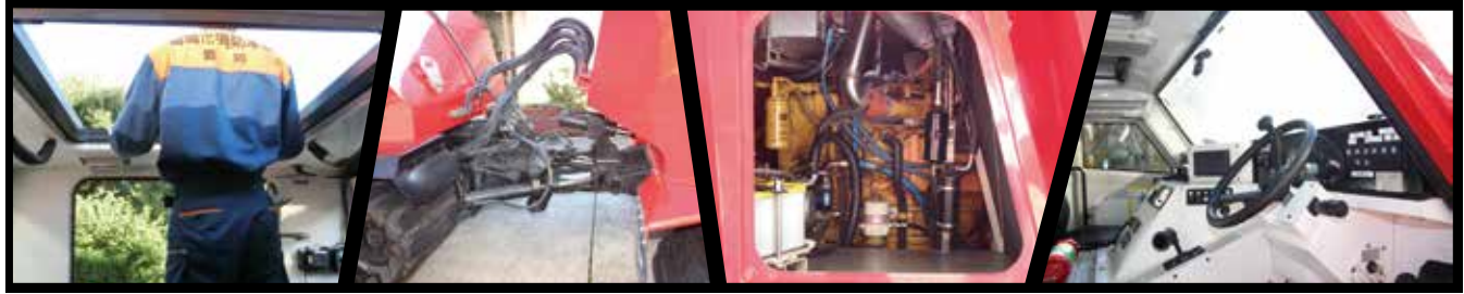
▲緊急脱出用の上部ハッチ (前部キャビンにも装備) ▲方向転換を油圧で操作する連結部分 ▲時速 50 キロを可能にする 7.2リットルディーゼルエンジン ▲自動変速機で乗用車のように操縦できる運転席
