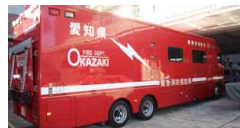
▲緊急消防援助隊を支援する車両 (停車時は車体を広げ、居住性を高めることができる)
