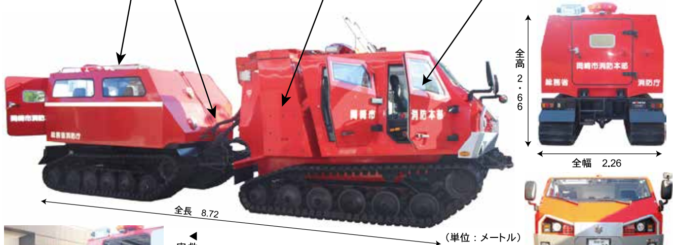
▲緊急脱出用の上部ハッチ (前部キャビンにも装備) ▲方向転換を油圧で操作する連結部分 ▲時速 50 キロを可能にする 7.2リットルディーゼルエンジン ▲自動変速機で乗用車のように操縦できる運転席
