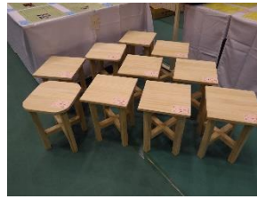
欠き継ぎをいかしたスツール
